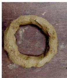
Test tactile au champ: la réalisation d'un boudin et le touché "poisseux" lorsque l'on pince alternativement la terre entre le pouce et l'index indique une teneur en argile supérieure à 40% sur cet échantillon (Trun, Calvados, 2017)
